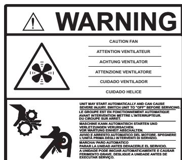
Рисунок 3. Предупреждение о состоянии вентилятора
