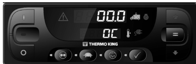
Рисунок 6. Стандартная панель управления HMI
